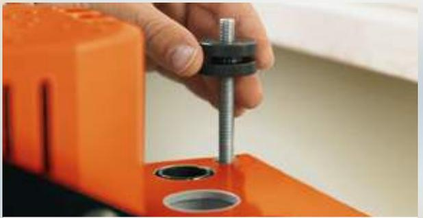
Глубина сверления точно устанавливается с помощью регулировочного винта.
