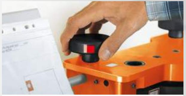
С помощью револьверной рукоятки с цветовой маркировкой можно установить глубину сверления для каждой конкретной ситуации. Пробное сверление больше не требуется.
