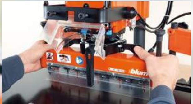
Для сверления серийных отверстий с шагом 32 мм можно использовать 9-шпindelную сверильную головку, а для обработки фасада и направляющих к корпусу – 8-шпindelную.
