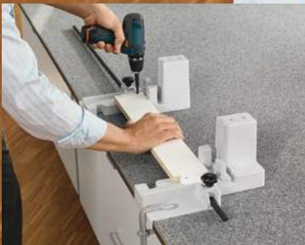
Задняя стенка из ДСП и держатели задней стенки фиксируются саморезами – точно и без зазоров.
