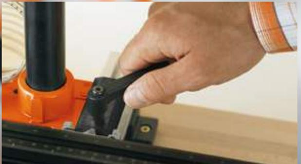
Точные позиции сверления устанавливаются и фиксируются с помощью зажимного рычага.
