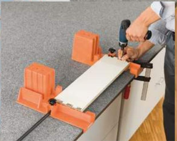
Задняя стенка из ДСП и держатели задней стенки фиксируются саморезами без зазоров.
