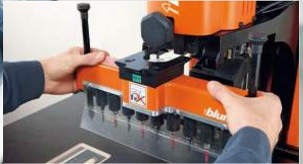
Сверильная головка, также обозначенная определенным цветом, устанавливается и крепится с помощью зажимного рычага без инструмента.
